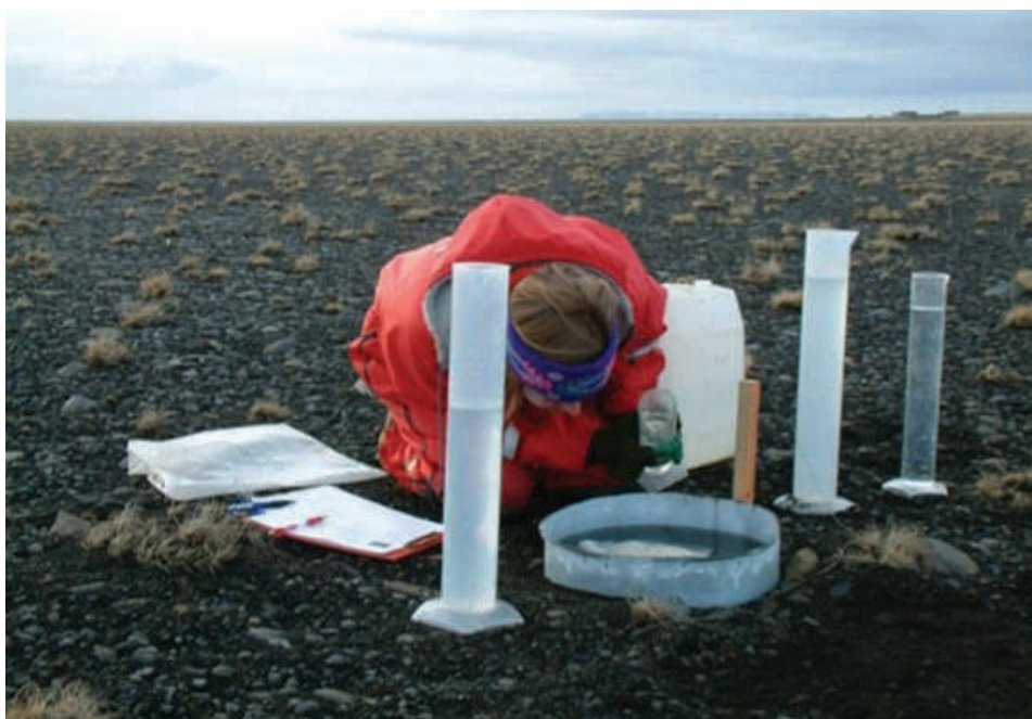
Mynd 4.5. Mæling á ísigi á Geitasandi nærri Gunnarsholti. Vatni er hellt í hringinn og viðhaldið 2–3 cm vatnsborði. Hér er ísigið mjög hægt að vetrarlagi og hætta á yfirborðsrennsli í vatnsveðrum og snjóbráð með tilheyrandi vatnsrofi.
